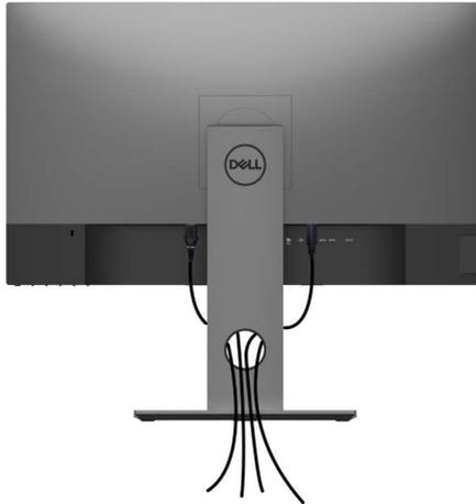
Organisieren Sie nach Anschluss aller erforderlichen Kabel an Ihrem Monitor und Computer (beachten Sie zum Kabelanschluss [Ihren Monitor anschließen](#)) diese wie oben gezeigt.
